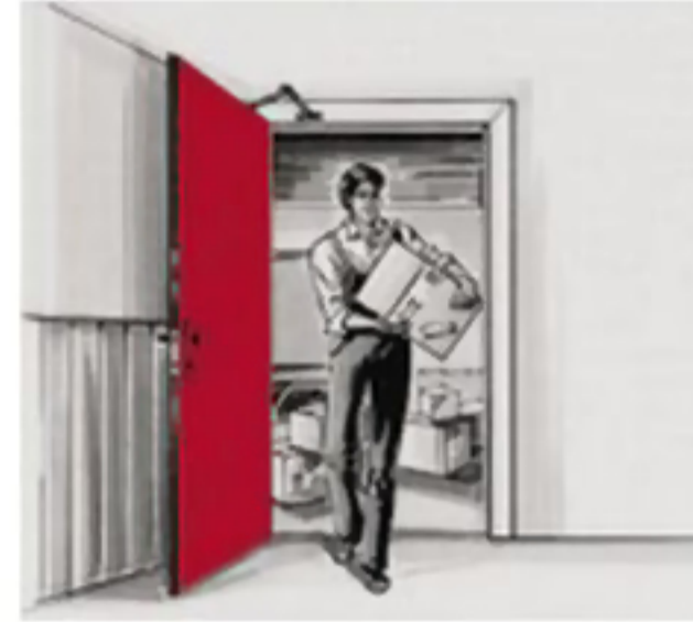
Spärruppställningsarmar får ej användas till branddörrar
